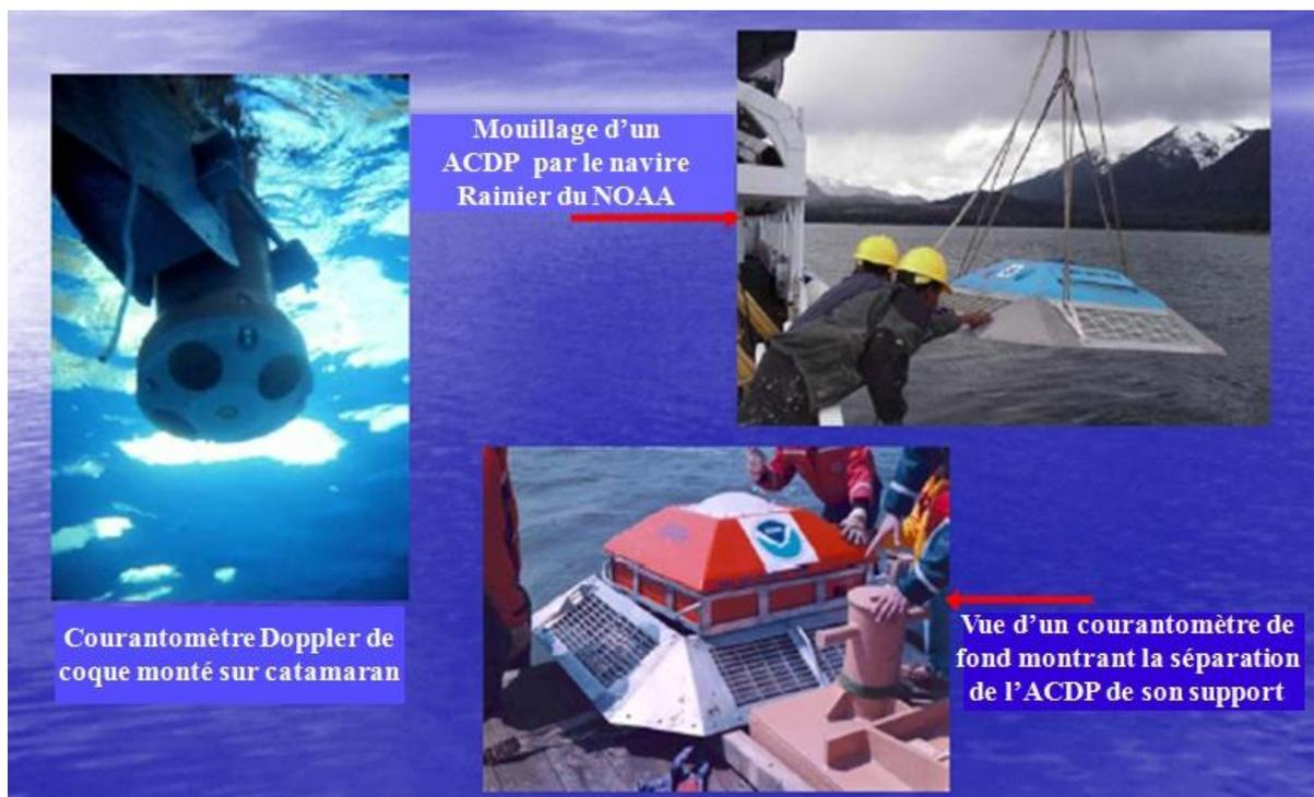
**Fig. 5.20 « Mise en œuvre de courantomètres Doppler (ADCP) »**
