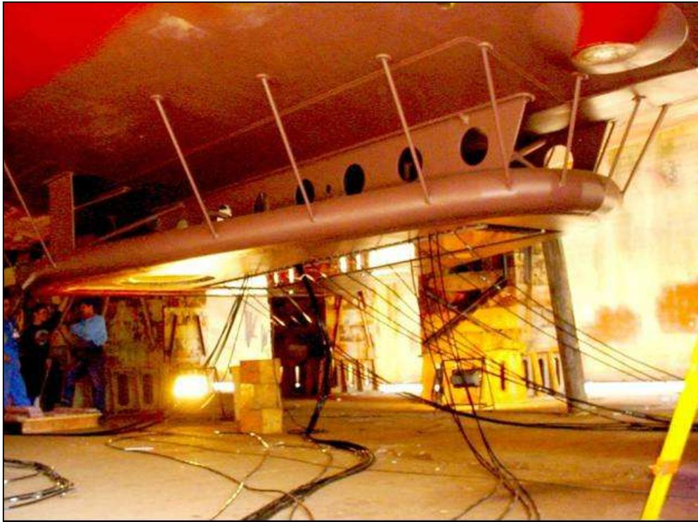
**Figura 3.18 "Instalação em gôndola "**
