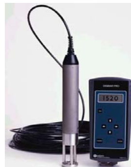
EQUIPO MEDIDOR DE LA VELOCIDAD DEL SONIDO DIGIBAR PRO ODOM
