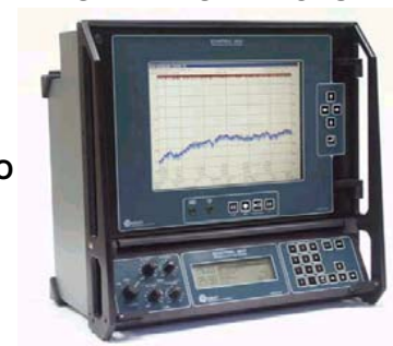
ECOSONDA MKIII ODOM DE DOBLE FRECUENCIA AGUAS SOMERAS MEDIAS Y PROFUNDAS
