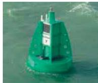
**B-460.4 La taille** des bouées varie à la fois suivant la distance de visibilité requise et les difficultés liées à leur emplacement (les eaux profondes et les forts courants de marée demandent des mouillages plus longs et plus lourds et par conséquent des flotteurs plus gros). On estime, en pratique, qu'il ne faut distinguer sur les cartes que deux tailles de bouées (en dehors des feux flottants principaux - voir B-474 et des bouées espar - voir B-462.2) :
