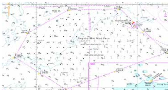
Lorsque le parc éolien (ou une grande partie de ce dernier) devient opérationnel et qu'il est confirmé que les aides à la navigation permanentes fonctionnent correctement, les cartes devraient être mises à jour afin d'intégrer toutes les caractéristiques appropriées à l'échelle de la carte.
