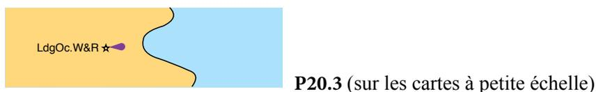
Les feux alignés marquant un danger ou une limite peuvent être cartographiés de façon similaire, sauf que l'abréviation 'Ldg' ne doit pas être utilisée et que la ligne de transit (ou d'alignement de garde) doit être totalement tiretée, par exemple :
