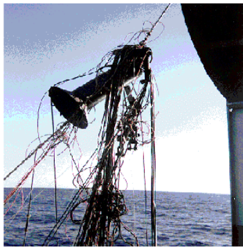
engin de pêche palangrière enchevêtré dans une ligne de mouillage TAO
