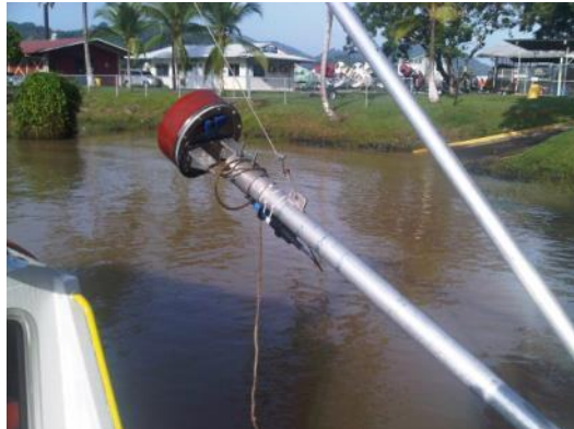
Cabeza del sonar Multibeam Kongsberg modelo EM3002
