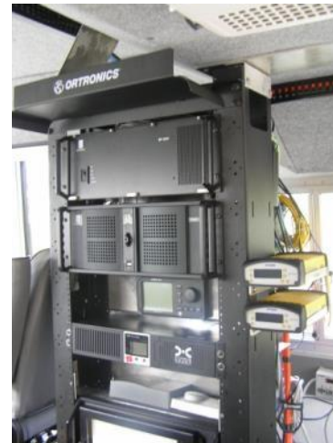
Computadora procesadora de los datos de Multibeam
