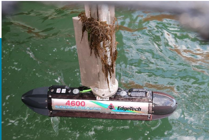
Edge Tech 4600: Batimetría MB e imágenes de Sonar de Barrido lateral
