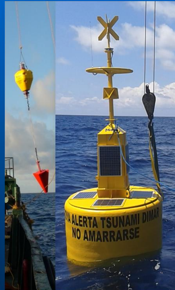
Sistema de detección y monitoreo de Tsunami
